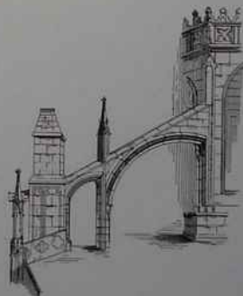
Section avec son arc-boutant sur la galerie des chapelles
